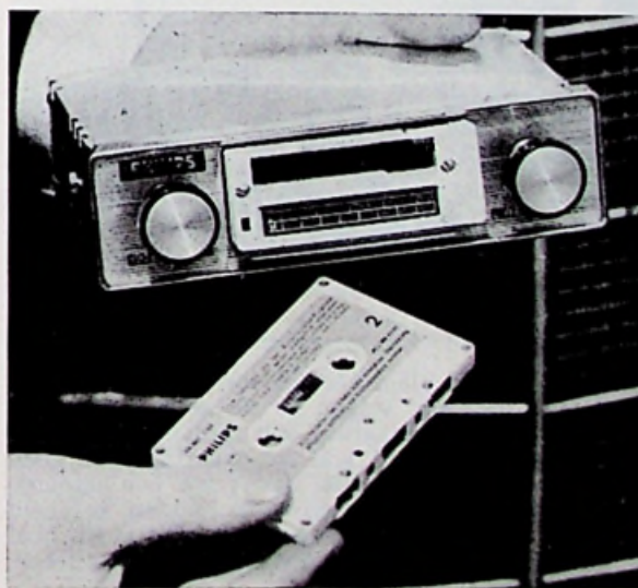
Afb. 3 - Philips cassetterecorder, gecombineerd met autoradio (Duitse produktie). Alleen weergave; snel vooruit- en terugspoelen is mogelijk. Middengolf, lange golf.
