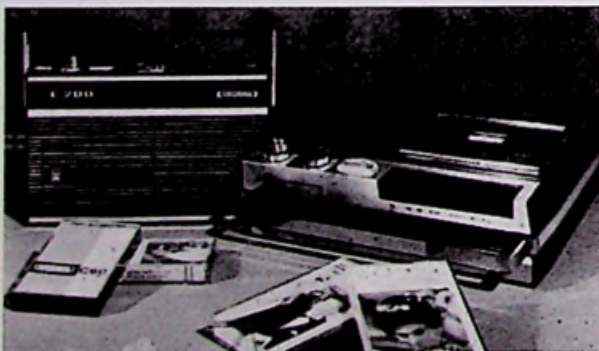
Afb. 12 - Rechts de Grundig recorder met de (vermoedelijk spoedig uitstervende) DC international-cassettes; links de zojuist uitgekomen Grundig recorder C 200 voor de Compact cassettes.
