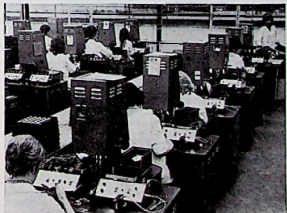
Afb. 1 - Een gedeelte van de montageruimte met de montage-machines, waarin het monteren van de membranen plaats vindt.
